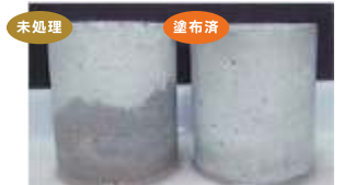
※毛細管による水の上昇の違いがはっきりとわかる。
